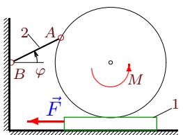
Точка  $A$  обода диска радиусом  $R$  соединена стержнем длиной  $R$  с неподвижным шарниром  $B$ , расположенным на одной высоте с центром диска. Диск катится без проскальзывания по пластине, расположенной на гладком основании. Масса пластины  $m_1$ , масса стержня —  $m_2$ . Момент  $M$  приложен к диску, горизонтальная сила  $F$  — к пластине. Составить уравнение движения системы. За обобщенную координату принять угол поворота стержня  $\varphi$ .
