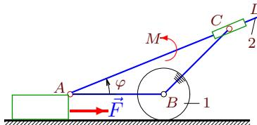
Стержень  $AD$  длины  $2a$  скользит в муфте  $C$ , шарнирно закрепленной на конце стержня  $BC = a$ , жестко скрепленного с диском массой  $m_1$  радиуса  $R$ . Ось диска соединена невесомым стержнем с призмой, скользящей по горизонтальной плоскости. Масса стержня  $AD$  равна  $m_2$ . К стержню  $AD$  приложен момент  $M$ , к призме — горизонтальная сила  $F$ ,  $AB = a$ . Составить уравнение движения системы. За обобщенную координату принять угол поворота стержня  $AD$   $\varphi$ .
