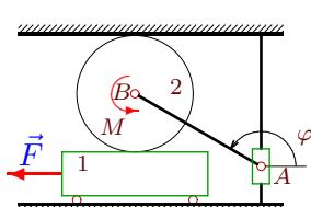
По вертикальной направляющей движется муфта  $A$ , шарнирно соединенная с диском радиусом  $R$ . Верхней точкой обода диск касается горизонтальной поверхности, нижней — бруска массой  $m_1$  на невесомых подшипниках. Масса диска  $m_2$ .  $AB = a$ . Составить уравнение движения системы. За обобщенную координату принять  $\varphi$ .
