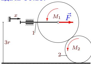
Цилиндр радиуса  $r$  катится по неподвижной поверхности и находится в зацеплении с цилиндром радиуса  $R = 1.5r$ , закрепленным шарнирно на горизонтальном штоке. К цилиндрам приложены моменты  $M_1$  и  $M_2$ , к штоку — горизонтальная сила  $F$ . Масса штока равна  $m_1$ , масса нижнего цилиндра —  $m_2$ . Составить уравнение движения системы. За обобщенную координату принять смещение штока  $x$ .
