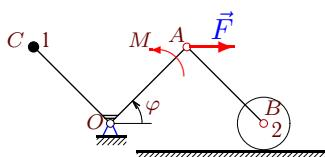
Стержни  $OC$  и  $OA$  жестко скреплены под углом  $90^\circ$ . В точке  $C$  расположена масса  $m_1$ . Масса цилиндра —  $m_2$ . К стержню  $OA$  приложен момент  $M$ . На шарнир  $A$  действует сила  $F$ .  $OA = OC = AB = a$ . Составить уравнение движения системы. За обобщенную координату принять  $\varphi$ .
