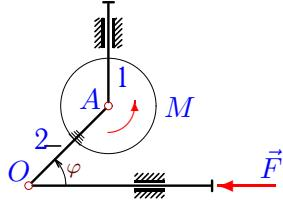
На вертикальном штоке шарнирно закреплен однородный диск 1 радиуса  $R$  массой  $m_1$ . Диск жестко соединен со стержнем 2 массой  $m_2$ . К диску приложен момент  $M$ , к штоку — сила  $F$ ;  $AO = a$ . Составить уравнение движения системы. За обобщенную координату принять  $\varphi$ .
