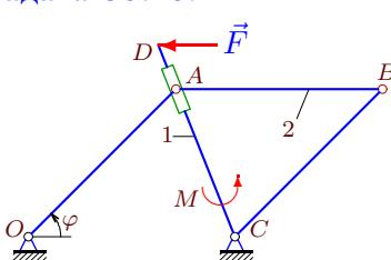
Муфта, шарнирно закрепленная в узле  $A$  четырехзвенника  $OABC$ , надета на кулису  $DC$  длиной  $a$ ;  $OA = AB = BC = OC = b$ . На кулису действует момент  $M$ , к точке  $D$  приложена горизонтальная сила  $F$ . Масса кулисы равна  $m_1$ , стержня  $AB$  —  $m_2$ . Составить уравнение движения системы. За обобщенную координату принять угол  $\varphi$ .
