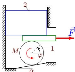
Между диском радиусом  $R$  и прессом зажата пластина, скользящая по гладкой поверхности пресса. Диск катится по наклонной ( $\alpha$ ) поверхности. Масса диска  $m_1$ , пресса —  $m_2$ . К диску приложен момент  $M$ , к пластине — горизонтальная сила  $F$ . Проскальзывание в точках контакта диска отсутствует. Составить уравнение движения системы. За обобщенную координату принять угол поворота диска  $\varphi$ .
