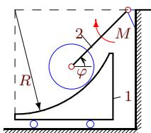
Груз массой  $m_1$  движется на невесомых подшипниках по горизонтальной плоскости. По цилиндрической поверхности груза радиусом  $R = 3r$  катится диск радиусом  $r$ , закрепленный на стержне длиной  $2r$ . К стержню приложен момент  $M$ . Масса стержня  $m_2$ . Составить уравнение движения системы. За обобщенную координату принять угол поворота стержня  $\varphi$ .
