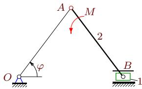
Механизм состоит из двух стержней одинаковой длины  $OA = AB = a$  и горизонтально движущегося ползуна  $B$  массой  $m_1$ . К стержню  $AB$  приложен момент  $M$ . Масса стержня  $AB$  равна  $m_2$ , массой стержня  $OA$  пренебречь. Составить уравнение движения системы. За обобщенную координату принять  $\varphi$ .
