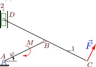
Стержень  $CD$  массой  $m_1$  и стержень  $AB$  шарнирно соединены.  $AB = BC = BD = a$ . Масса ползуна, скользящего по вертикальной плоскости, равна  $m_2$ . К стержню  $AB$  приложен момент  $M$ ; сила  $F$  перпендикулярна  $CD$ . Составить уравнение движения системы. За обобщенную координату принять  $\varphi$ .
