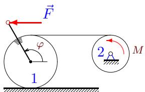
Цилиндр массой  $m_1$  радиуса  $R$  жестко соединен с невесомым стержнем длиной  $a$ . Нить, параллельная основанию, по которому катится цилиндр, связывает его с диском массой  $m_2$  радиуса  $r$ . Составить уравнение движения системы. За обобщенную координату принять  $\varphi$ .
