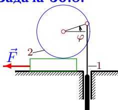
Вертикально движущийся поршень массой  $m_1$  закреплен шарнирно на ободе диска радиусом  $R$ . Диск без проскальзывания катится по пластине, лежащей на гладкой плоскости. К пластине приложена сила  $F$ . Масса диска  $m_2$ . Составить уравнение движения системы. За обобщенную координату принять угол поворота диска  $\varphi$ .
