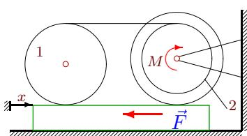
Цилиндр массой  $m_1$  катится без проскальзывания по бруски, скользящему по гладкой горизонтальной поверхности. По этому же бруски катится и блок (внешний радиус  $R$ , внутренний —  $r$ ) с неподвижной осью. Цилиндр и блок огибают горизонтальную нить. Масса блока  $m_2$ . Момент инерции блока  $J$ . На блок действует момент  $M$ , на бруск — горизонтальная сила  $F$ . Составить уравнение движения системы. За обобщенную координату принять координату  $x$  бруска.
