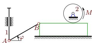
Стержень  $AB = a$  соединяет вертикальный поршень массой  $m_1$  и горизонтально движущийся брускок. Брускок вращает цилиндр радиуса  $R$  массой  $m_2$ . К цилиндру приложен момент  $M$ . Составить уравнение движения системы. За обобщенную координату принять  $\varphi$ .
