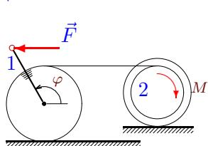
Цилиндр радиуса  $R$  жестко соединен с однородным стержнем массой  $m_1$  длиной  $a$ . Нить, параллельная основанию, по которому катится цилиндр, связывает его с внутренним ободом блока массой  $m_2$ . Радиусы блока  $R_0$  и  $r_0$ , момент инерции  $J_0$ . Составить уравнение движения системы. За обобщенную координату принять  $\varphi$ .
