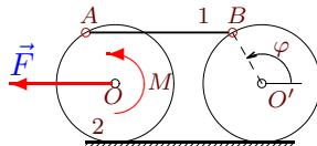
Два диска шарнирно соединены спарником  $AB$  массой  $m_1$ . К диску массой  $m_2$  приложен момент  $M$  и горизонтальная сила  $F$ . Второй диск считать невесомым;  $AB \parallel OO'$ . Составить уравнение движения системы. За обобщенную координату принять  $\varphi$ .
