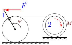
Цилиндр радиуса  $R$  жестко соединен с однородным стержнем массой  $m_1$  длиной  $a$ . Нить, параллельная основанию, по которому катится цилиндр, связывает его с внутренним ободом блока массой  $m_2$ . Радиусы блока  $R_0$  и  $r_0$ , момент инерции  $J_0$ . Составить уравнение движения системы. За обобщенную координату принять  $\varphi$ .
