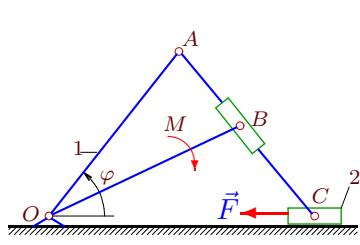
На стержень  $AC$  двухзвенника  $OAC$  надета невесомая муфта  $B$ , шарнирно закрепленная на кривошипе  $OB$  длиной  $a$ . К кривошипу приложен момент  $M$ , к ползуну  $C$ , скользящему по горизонтальной поверхности, сила  $F$ ;  $OA = AC = a$ . Масса стержня  $OA$  равна  $m_1$ , масса ползуна  $C$  —  $m_2$ . Составить уравнение движения системы. За обобщенную координату принять угол поворота стержня  $OA \varphi$ .
