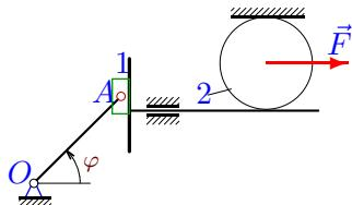
Брускок  $A$  массы  $m_1$ , закрепленный на кривошиле  $OA$ , скользит по поверхности поршня. Поршень приводит в движение цилиндр массы  $m_2$ . К оси цилиндра приложена горизонтальная сила  $F$ .  $AO = a$ . Составить уравнение движения системы. За обобщенную координату принять  $\varphi$ .
