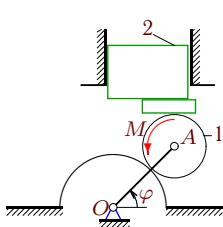
Диск радиусом  $r$  массы  $m_1$  катится по поверхности неподвижного цилиндра радиусом  $R$  и находится в зацеплении с бруском, скользящим по нижней грани пресса массой  $m_2$ , движущегося вертикально. К диску радиуса  $r$  приложен момент  $M$ , к прессу — вертикальная сила  $F$ . Составить уравнение движения системы. За обобщенную координату принять угол поворота стержня  $\varphi$ .
