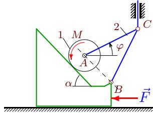
Стержень  $BC$  длины  $a$  шарнирно соединяет горизонтально скользящую призму и вертикальный шток  $C$ . Стержень  $AC = a$  соединен с осью диска  $A$  радиуса  $r$ , который катится по наклонной грани призмы. Масса диска  $A$  равна  $m_1$ , стержня  $AC = m_2$ . К диску приложен момент  $M$ , к призме — горизонтальная сила  $F$ . Составить уравнение движения системы. За обобщенную координату принять угол поворота стержня  $AC \varphi$ .
