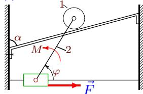
Диск массой  $m_1$  радиусом  $R$  катится по наклонной балке. Стержень длиной  $L$  соединяет муфту, скользящую по горизонтальной направляющей, с осью диска. Момент  $M$  приложен к стержню, сила  $F$  — к муфте. Масса стержня  $m_2$ . Составить уравнение движения системы. За обобщенную координату принять  $\varphi$ .
