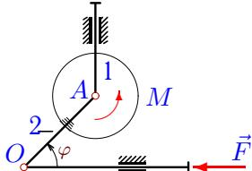
На вертикальном штоке шарнирно закреплен однородный диск 1 радиуса  $R$  массой  $m_1$ . Диск жестко соединен со стержнем 2 массой  $m_2$ . К диску приложен момент  $M$ , к штоку — сила  $F$ ;  $AO = a$ . Составить уравнение движения системы. За обобщенную координату принять  $\varphi$ .
