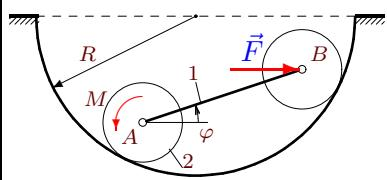
Оси цилиндров одинакового радиуса  $r$  соединены стержнем  $AB = 3r\sqrt{2}$  массой  $m_1$ . Цилиндры катятся по поверхности радиуса  $R = 4r$ . Масса цилиндра  $A$  равна  $m_2$ . К оси  $B$  приложена горизонтальная сила  $F$ , к цилинду  $A$  — момент  $M$ . Составить уравнение движения системы. За обобщенную координату принять угол поворота стержня  $\varphi$ .
