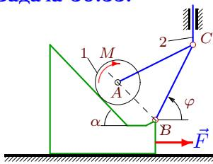
Стержень  $BC$  длины  $a$  шарнирно соединяет горизонтально скользящую призму и вертикальный шток  $C$ . Стержень  $AC = a$  соединен с осью диска  $A$  радиуса  $r$ , который катится по наклонной грани призмы. Масса диска  $A$  равна  $m_1$ , штока —  $m_2$ . К диску приложен момент  $M$ , к призме — горизонтальная сила  $F$ . Составить уравнение движения системы. За обобщенную координату принять угол поворота стержня  $BC$   $\varphi$ .
