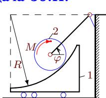
Груз массой  $m_1$  движется на невесомых подшипниках по горизонтальной плоскости. По цилиндрической поверхности груза радиусом  $R = 4r$  катится диск радиусом  $r$ , закрепленный на стержне длиной  $3r$ . К диску приложен момент  $M$ . Масса диска  $m_2$ . Составить уравнение движения системы. За обобщенную координату принять угол поворота стержня  $\varphi$ .
