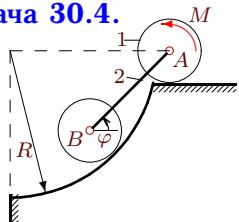
Оси двух дисков радиусами  $r$  соединены стержнем длиной  $3r$ . Диск  $A$  массой  $m_1$  катится по горизонтальной поверхности, другой — по цилиндрической поверхности радиусом  $R = 4r$ . К диску  $A$  приложен момент  $M$ . Масса стержня  $m_2$ , массой диска  $B$  пренебречь. Составить уравнение движения системы. За обобщенную координату принять угол поворота стержня  $\varphi$ .
