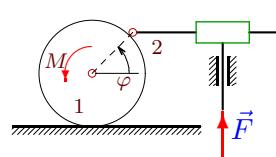
Сквозь муфту, закрепленную на вертикальном штоке, скользит горизонтальный стержень, соединенный шарниром с ободом цилиндра. Масса цилиндра  $m_1$ , радиус —  $R$ . Масса стержня  $m_2$ . К цилинду приложен момент  $M$ , к штоку — сила  $F$ . Составить уравнение движения системы. За обобщенную координату принять  $\varphi$ .
