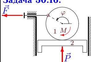
Цилиндр массой  $m_1$  радиусом  $R$  находится на поверхности поршня массой  $m_2$ . Шток, движущийся в горизонтальных направляющих, шарнирно прикреплен к ободу цилиндра. Момент  $M$  приложен к цилиндру, сила  $P$  — к поршню,  $F$  — к штоку. Составить уравнение движения системы. За обобщенную координату принять  $\varphi$ .
